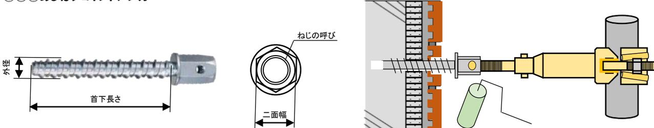
※透明樹脂を塗布する場合、外壁から約15mm浮かせた状態であしばジョイントアンカーを施工する。躯体埋込長さ55mmを必ず確保し適正なサイズのアンカーを使用する。
